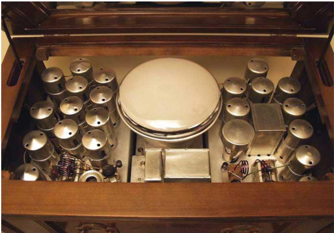
Na obrázku je vidieť televízny prijímač s 9'' zrkadlovou obrazovkou z roku 1936.
