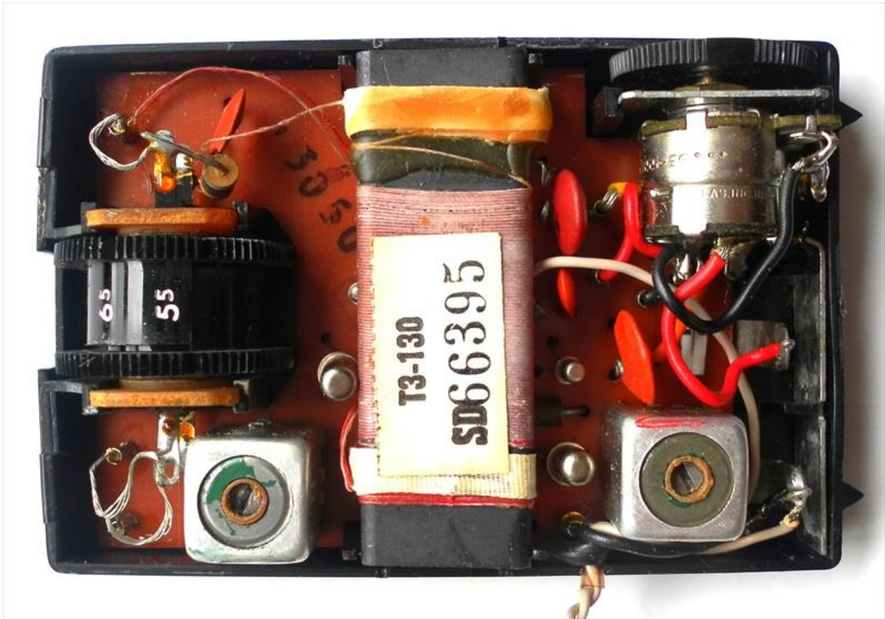
Na obrázku je uloženie súčiastok na doske plošných spojov rádioprijímača VeeP.
