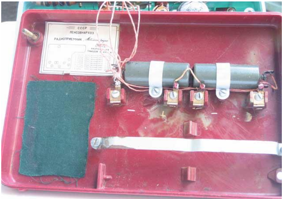
Na obrázku je vidieť uloženie súčiastok a zapojenie batérie rádia Atmosféra z roku 1959.
