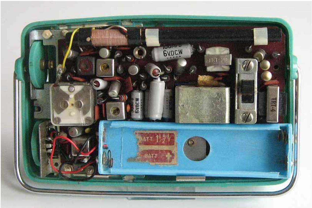
Na obrázku je vidieť rozloženie súčiastok v rádioprijímači TR – 800.
