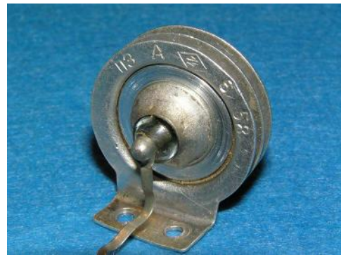
PNP výkonovým tranzistorom s prúdom 150 mA a napätím 25 voltov so ziskom 17 dB.
